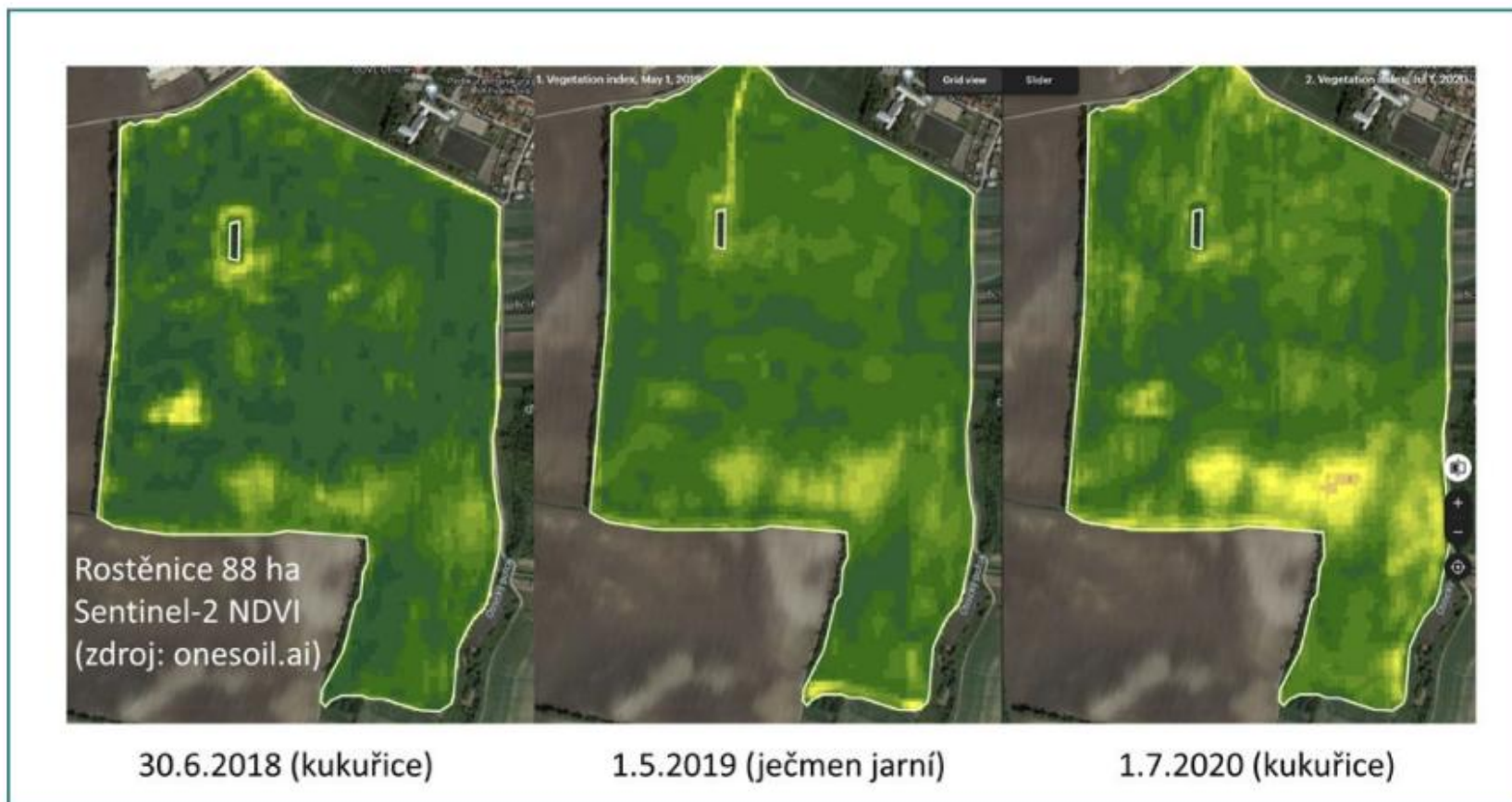
Obrázek 34: Vymezení produkčních zón z družicových snímků vychází z hodnocení zapojení stavu porostů v jednotlivých ročnících – méně produkční místa vykazují opakovaně nižší hodnoty vegetačních indexů (příklad NDVI ze Sentinel 2) [Lukas, V., 2021]
