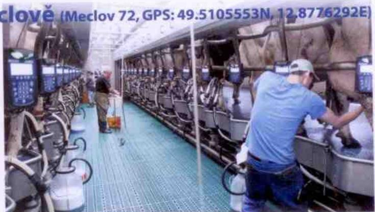
Nová rybinová dojírna 2 x 1 x 16 stání na farmě Srby. Na nerezovém hrazení dojirny se sinusovou hranou je osazena kompletní technologie dojení FARMTEC s novým typem elektroniky a měřiči nádoje lMilk 600. Je zde také systém dezinfekce dojicího stroje po každé kravě s automatickým ošetřením struk Air Wash.
